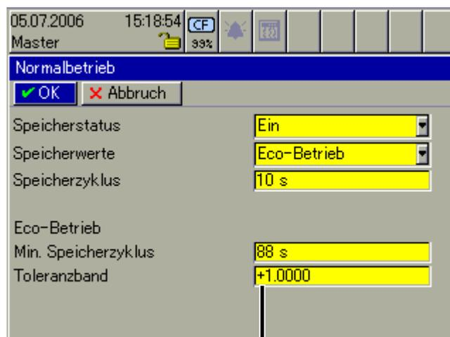
Das Toleranzband wird angegeben in Bezug auf die Einheit der Analogkanäle (z. B.  $\pm 1$  °C).
