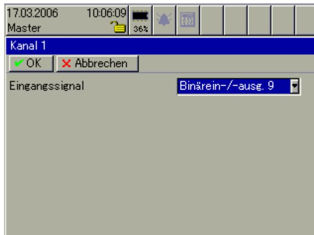
**Eingangssignal** Hier wird der Binäreingang/-ausgang oder das Signal gewählt, der/das als Binärkanal verwendet und visualisiert werden soll. Max. können 6 Binärkanäle in einer Gruppe visualisiert und erfasst werden.
